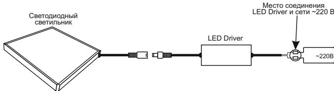
Рисунок 2 — Схема подключения изделия
